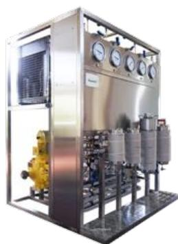
In questo caso si utilizza l’anidride carbonica (CO<sub>2</sub>) che, in determinate condizioni di temperatura e pressione, si trova in uno stato fisico con caratteristiche in parte analoghe a quelle di un liquido e in parte a quelle di un gas.
